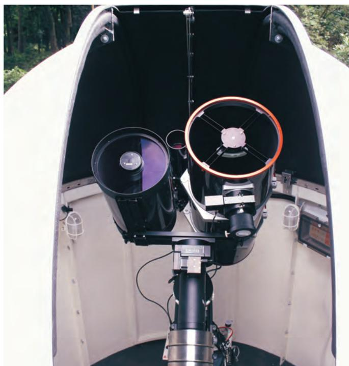
Finale Variante mit 12“ Newton, 11“ SC und Leitrohr
