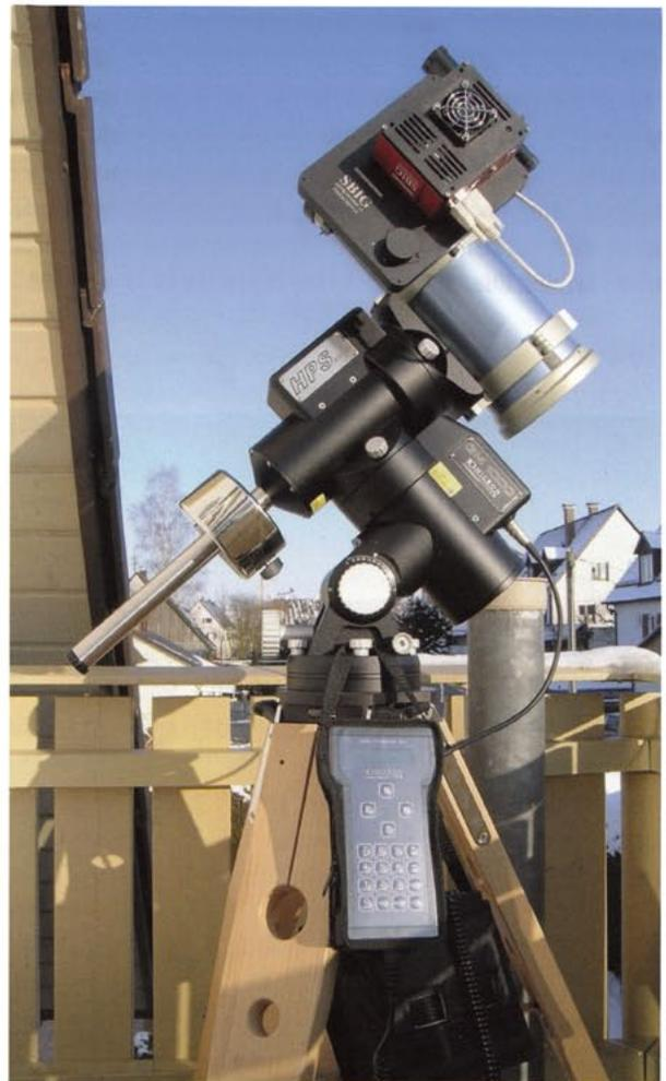
▲ Abb. 1: Das Modell GM 1000 HPS des italienischen Herstellers 10Micron arbeitet mit internen Absolut-Encodern.
