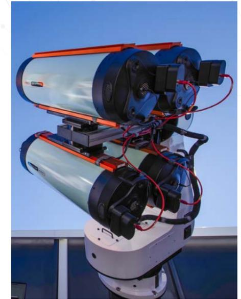
Eine parallele Montage zweier (oder mehrerer) Teleskope auf ein- und derselben Montierung eröffnet vielfältige Anwendungsmöglichkeiten, stellt jedoch auch besondere Anforderungen an Planung und Ausführung. Zentrales Ziel ist, mehrere Instrumente gleichzeitig sicher und stabil zu betreiben, ohne Abstriche bei optischer Leistung, Nachführung und mechanischer Präzision hinnehmen zu müssen.
